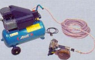
**Пневматичен пистолет за гвоздеи**
